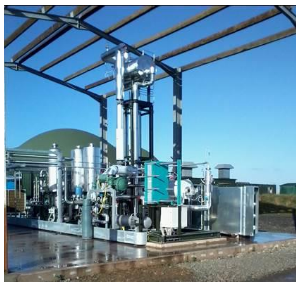
Plateforme de production de CO2 liquide de 600 kg/h
